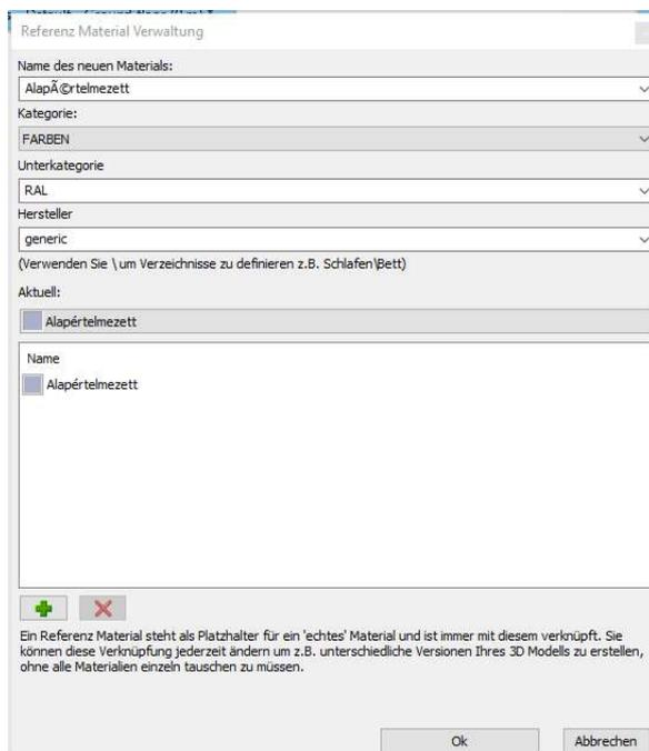
Im Dialog können Sie neue Materialien hinzufügen, aus der Gruppe löschen und ein neues auswählen. Wenn Sie den Dialog mit Ok schließen, ersetzt das Programm das angegebene Material durch das aktuelle. Achtung der Materialname bleibt gleich!
